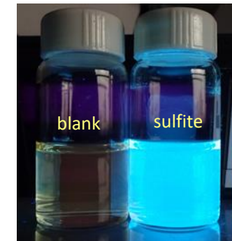
Imagen que muestra fluorescencia en presencia de sulfito (365 nm)
